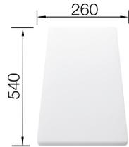
An den Außenkanten der Spüle geführtes Schneidbrett, erhältlich in massiver Buche oder Kunststoff, geeignet für Spülenbreiten 435 mm, 500 mm und 510 mm
