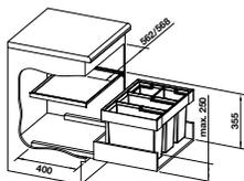
Das System für den Einbau in vorhandene Auszüge, **es wird daher ein Auszug mit Front vom Küchenhersteller benötigt**. Einbauhöhe 370mm ab Oberkante Schubkastenboden, Einbautiefe 400mm, Maximale Zargenhöhe 265mm, Systemabdeckung = Ablageboden zur Montage im Spülenschrank inkl. Für Kasettentüren ab 90 mm Rahmen geeignet, inkl. Deckel für einen 6l Eimer
