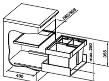
Das System für den Einbau in vorhandene Auszüge, **es wird daher ein Auszug mit Front vom Küchenhersteller benötigt**. Einbauhöhe 370mm ab Oberkante Schubkastenboden, Einbautiefe 400mm, Maximale Zargenhöhe 265mm, Systemabdeckung = Ablageboden zur Montage im Spülenschrank inkl. Für Kasettentüren ab 90 mm Rahmen geeignet, inkl. Deckel für einen 8l Eimer
